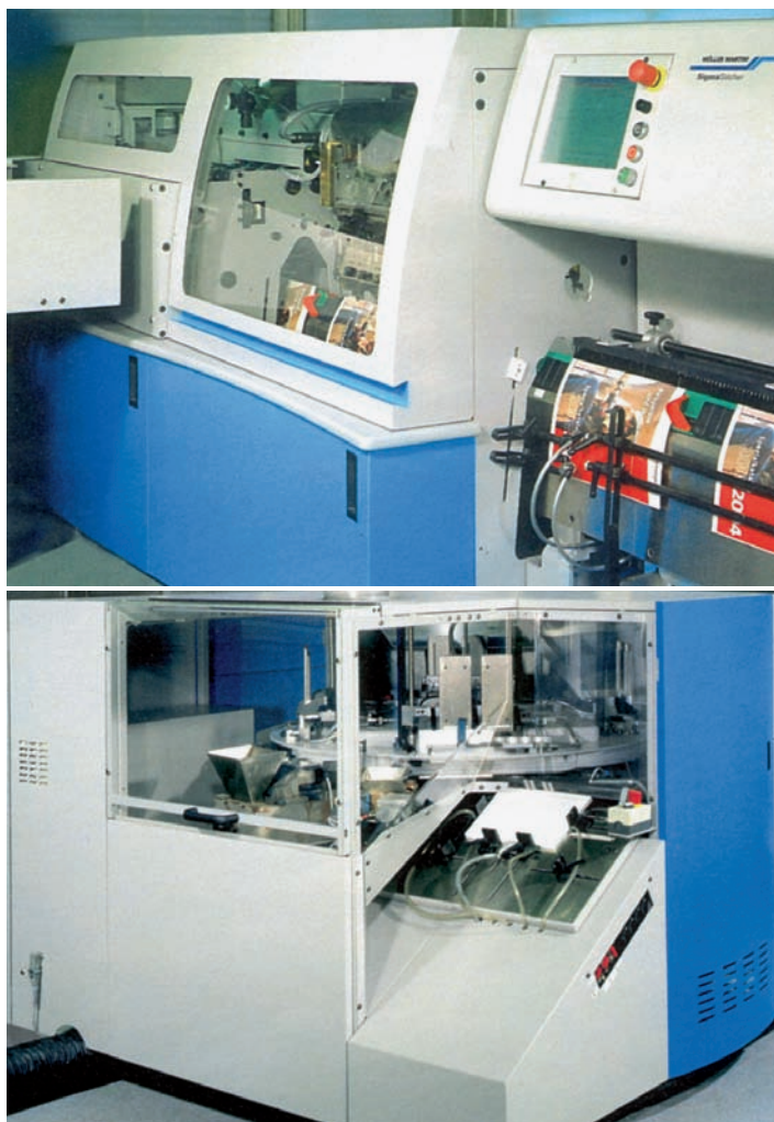
Slika 9. Revialka oz. znašalno-šivalni stroj Sigma Sticher (zgoraj) in stroj za lepljeno vezavo Sigma Binder (spodaj) sta srce knjigoveške linije Sigma Line.
