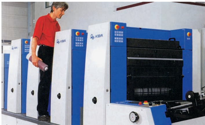
Slika 6. Drugo nagrado za inovacije v grafični dejavnosti so dodeli ofsetnemu stroju KBA Rapida 74 G (prvo si je prislužil I-papir, opisan v prejšnji številki, tretjo pa Spectrodens). Stroj ima mnogo posebnosti, najpomembnejša pa je barvni sistem GravufLOW z rastrskim valjem, barvno komoro (rakelji in nož), zato brez conskega upravljanja nabarvanja tiskovne forme.
