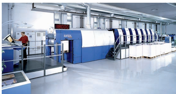
Za tisk embalaže je mogoče Rapido 105 opremiti z lakirnimi členi, sušilnimi napravami in dvakrat podaljšanim izlagalnikom. To omogoča tudi uporabo hibridnega oplemenitenja.
