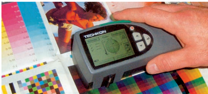
Slika 5. Spectrodens v uporabi: ergonomska uporaba in pregledno razporejeni elementi za upravljanje so bili pri razvoju, kakor zagotavlja proizvajalec, prav tako pomembni kot kratki merilni časi in pregledeno podajanje meritev na zaslonu.
