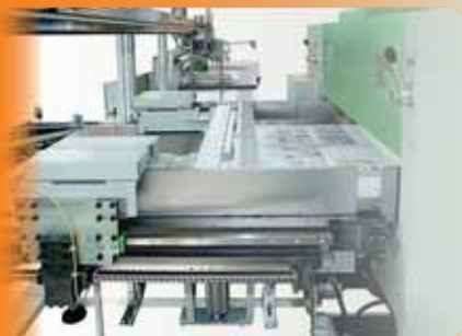
Zadnji del mize Perfecta 132 S-TS s sistemom prostega vlaganja od zadaj.
