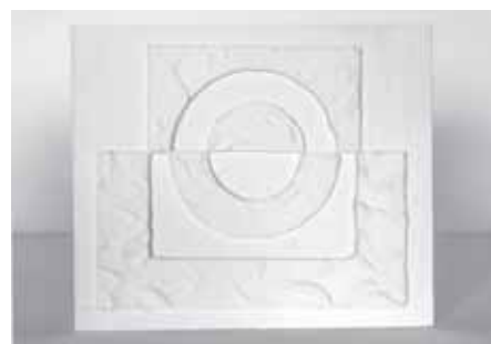
Slika 10: Model, zajet s 3D-skenerjem Artec Space Spider, po naknadni obdelavi
