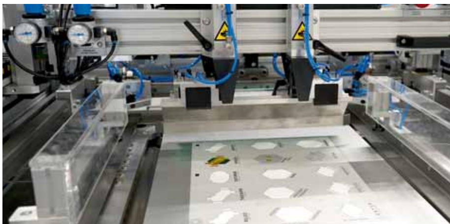
S sitotiskarskim strojem na digitalno sliko nanesemo sloj sitotiskarske barve, ki predstavlja ozadje grafike.
