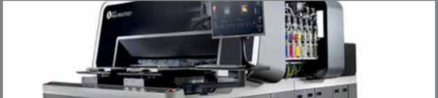
Novi Atlas Max Poly znamke Kornit omogoča neposredni tisk na poliestrske tkanine. (Slika: Kornit)
