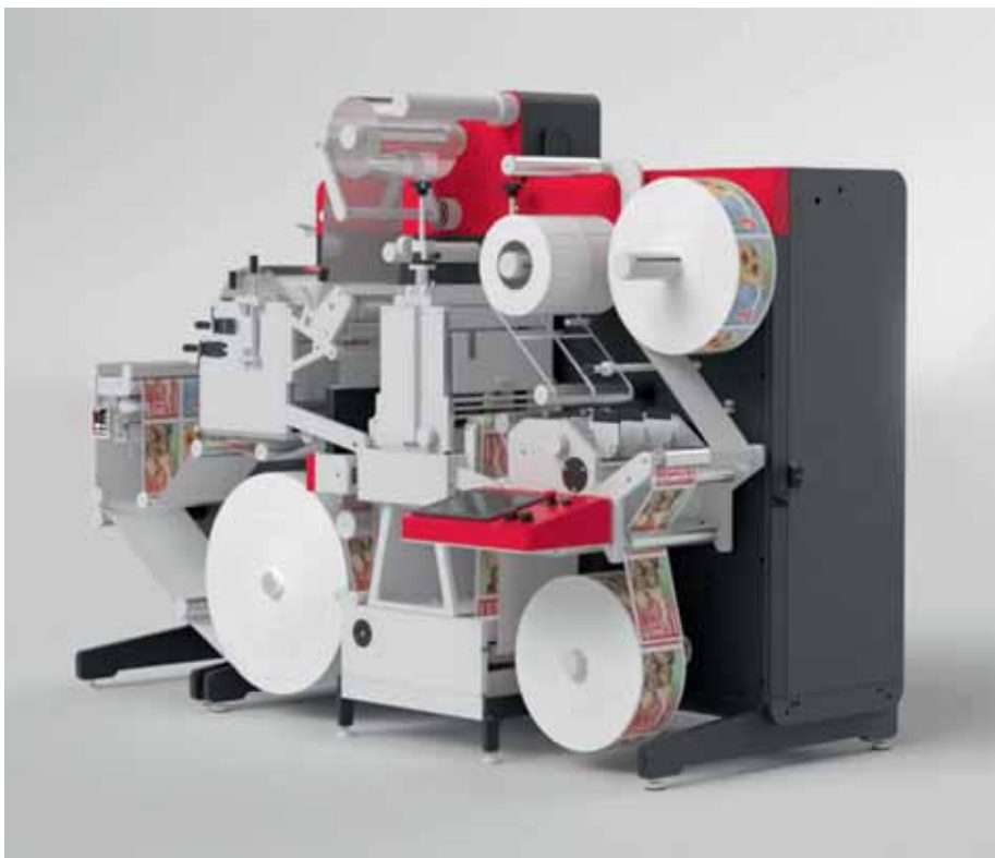
V novi seriji dodelavnih enot sta dva modela: Xeikon LCU350 kot modularna dodelavna platforma in Xeikon LCU33, osnovna in vstopna različica. S Xeikonovo serijo LCU so na voljo laminacija, izsekovanje, rezanje, navijanje, aplikacija vroče folije in sitotisk.
